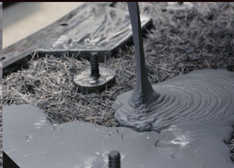
2 Écoulement de la matrice sur les fibres
