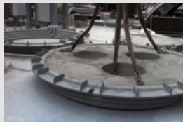
Gewölbedecke für Lichbogenofen mit metallischer Umspannung Voûtain de four à arc avec ceinture
