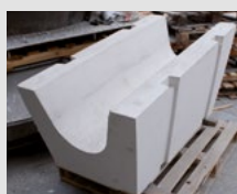
Rinne des Lichtbogenofens Chenal de four
