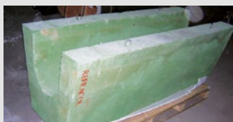
Mit Chromoxid dotierte Rinne für Lichtbogenofen Chenal de FE dopé chrome
