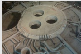
Gewölbenherz auf dem Ofendeckel Cœur de voûte sur le couvercle du four
