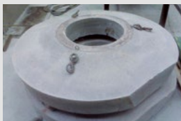
VAD-Entgasungsgewölbe Voûte de dégazage ASV
