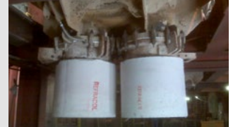
Rüssel auf Gefäßboden Plongeurs monoblocs montés sur le bas de cuve
