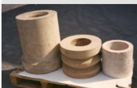
Set of sleeves for hearth of DC EAF Jeu de viroles de sole de four à arc à courant continu
