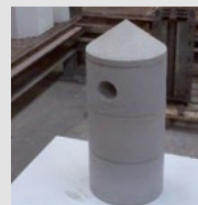
Temperature probe Tower Chapelle de four à longerons
