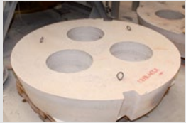
Heart of roof Cœur de voûte
