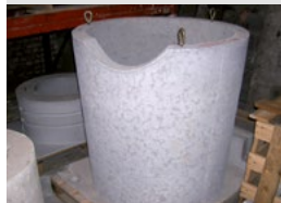
Monolithic foundry Ladle Poche monobloc de fonderie
