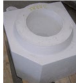
Pouring square block Brique de siège de coulée
