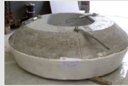
Monolithic roof of DC EF Voûtain Monobloc de four à courant continu
