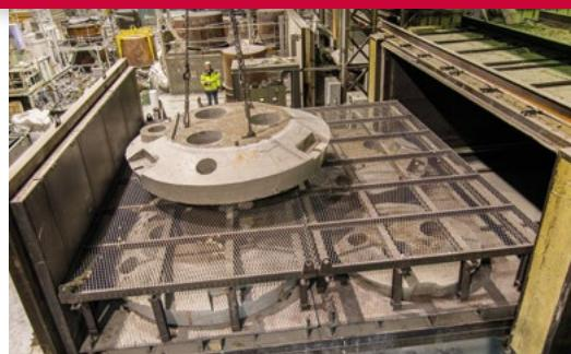
Pièces en béton étuvées jusqu'à 600°C. Petites et moyennes séries de 10 kg à 12 tonnes. Pièces fabriquées suivant les spécifications des clients et à partir de bétons réfractaires sélectionnés pour résister aux chocs thermiques, aux températures élevées, aux attaques chimiques et/ou à l'abrasion.
