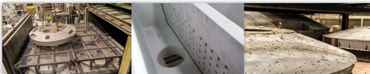
Piezas prefabricadas secadas hasta 450 °C. Producciones en serie pequeñas o medianas, de 10 kg a 20 toneladas. Piezas prefabricadas diseñadas a partir de especificaciones y dibujos de los clientes. Piezas refractarias fabricadas con nuestras hormigóns de alto rendimiento, seleccionadas para resistir, según la demanda, choques térmicos, altas temperaturas, ataques químicos y/o abrasión. Nuestra calidad **FibroCeram®** es ideal para aplicaciones con choques mecánicos y altas temperaturas.
