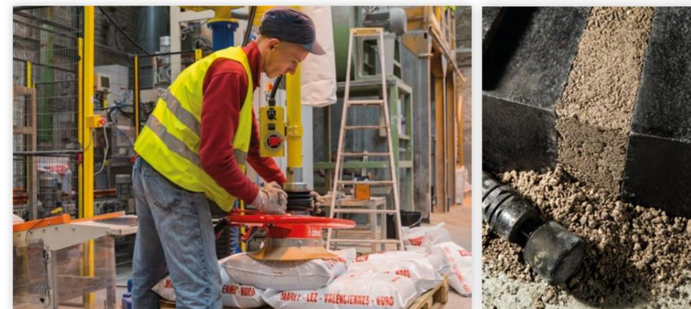
Mezclas de apisonado secas o húmedas, de alta magnesia o alto contenido de alúmina, con fraguado cerámico o químico.
