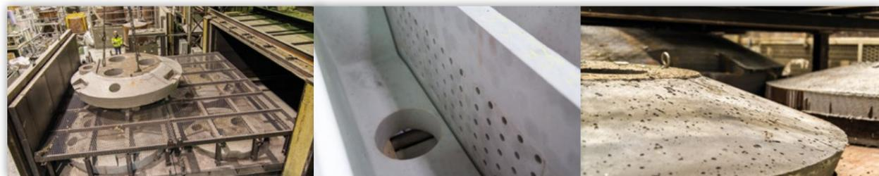
Pièces en béton étuvées jusqu'à 450°C. Petites et moyennes séries de 10 kg à 20 tonnes. Pièces préfabriquées conçues à partir des spécifications et des dessins des clients. Pièces réfractaires fabriquées à partir de nos mélanges de bétons à haute performance sélectionnés pour résister, selon la demande, aux chocs thermiques, aux températures élevées, aux attaques chimiques et/ou à l'abrasion.
