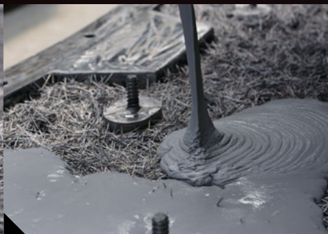
2 Écoulement de la matrice sur les fibres
