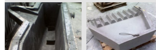
Beton-Dauerfutter Garnissage du béton permanent Einteiliger Verteiler Répartiteur monobloc Beton-Dauerfutter Garnissage du béton permanent
