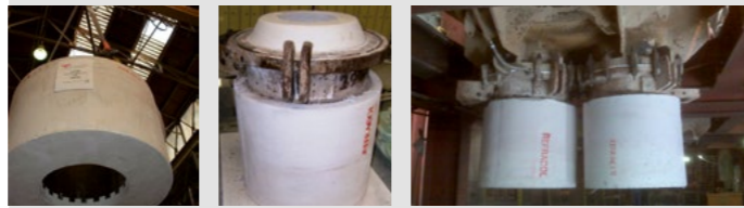
Castable lining of snorkel Garnissage de plongeur en béton Monolithic snorkel Plongeur monobloc Snorkels placed under the vessel Plongeurs monoblocs montés sur le bas de cuve
